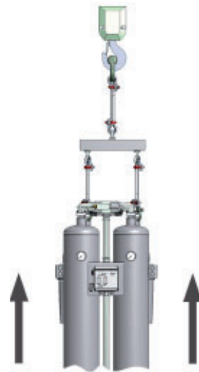
II: Opstellen met kraan
